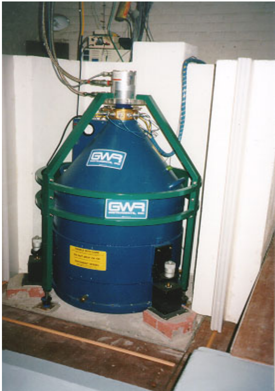
Gravimètre supraconducteur GWR CO26 en fonctionnement à l'Observatoire Gravimétrique de Strasbourg et localisation des différents réseaux permanents géophysiques dans le Nord-Est de la France (sismologie, GPS, magnétisme, etc.).
